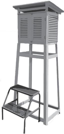
Es una casilla de madera que se pinta de color blanco para evitar que la radiación solar afecte los instrumentos instalados dentro y el diseño tanto del techo como de las paredes garantiza la seguridad de los instrumentos que están en su interior.
